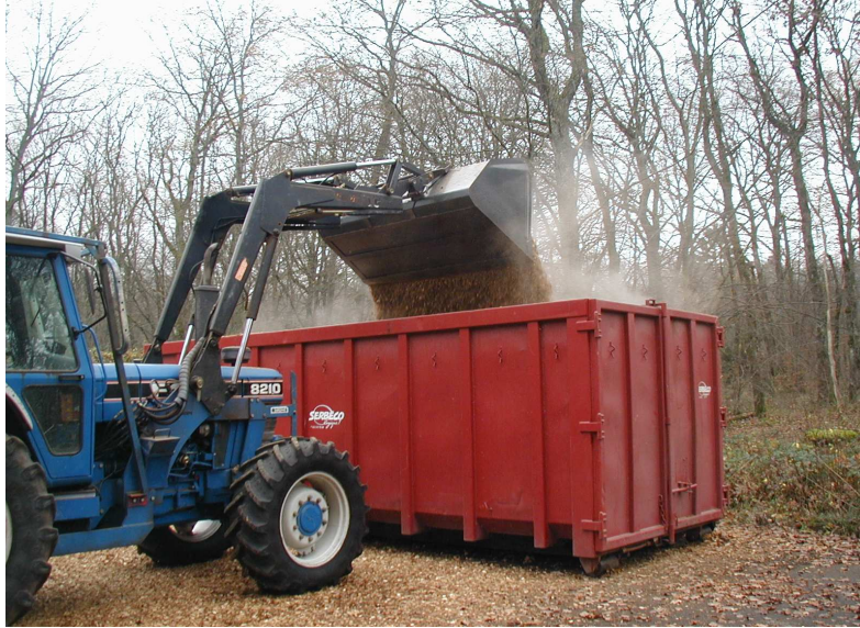
Image 1 : Pelle mécanique remplissant une benne de plaquettes. Le godet contient environ 2 m 3 de matière.
