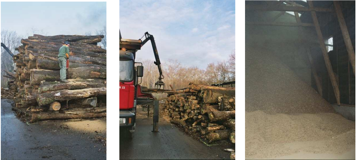
Figure 2 : Tas de troncs en attente du déchetage ; récolte de rondelles à partir des troncs. Figures 3 et 4: Déchetage par le camion de l'Association SODEFOR II. Les troncs entiers passent dans les couteaux et sont directement injectés dans le hangar de stockage sous forme de plaquettes. Sur la figure 4, on constate une différence dans l'apparence des restes de plaquettes du tas précédent (au premier plan) et des plaquettes du nouveau tas.
